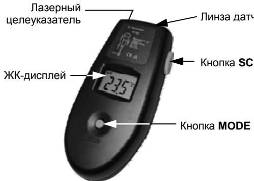
Кнопка **SCAN** – включение и осуществление замера температуры
